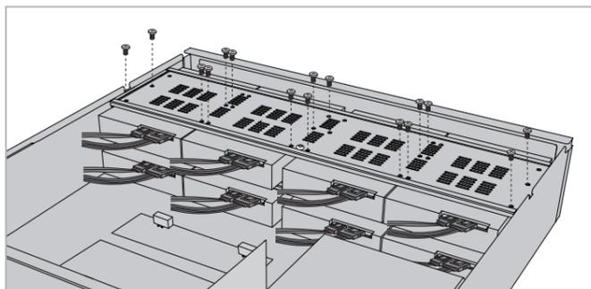
2. 打开机箱上盖，取出上层硬盘支撑板；将硬盘上的螺丝对准硬盘支撑板上的预留孔，拧紧螺丝；再使用相同方法安装下层的其余三块硬盘。将上层支撑板的凹槽与机箱两侧的螺钉扣合，并将硬盘支撑柱固定在上、下层支撑板之间。
