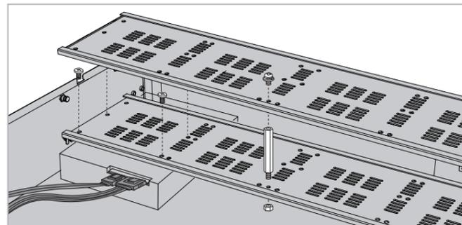
4. 建议在安装完所有硬盘后，再分别将硬盘数据线和电源线另一端连接在设备主板上。最后将机箱上盖安装回设备。
